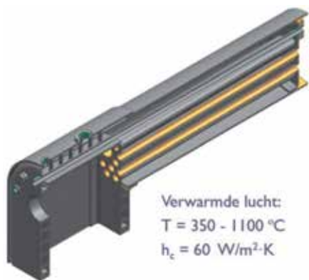
Figuur 8 - Warmtestroom in de vlampijpen
